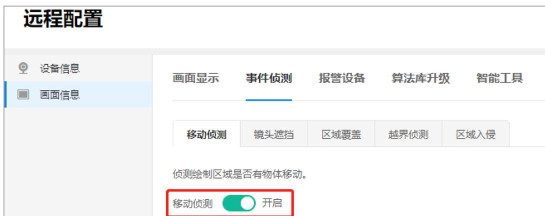
2. 移动侦测功能开启后，默认全局移动侦测。若需要自定义设置检测区域，可点击屏幕右下角的<清空>按钮，在视频监视窗口中单击鼠标左键并拖动鼠标，松开鼠标左键，绘制移动侦测区域。最多可绘制4个移动侦测区域。
