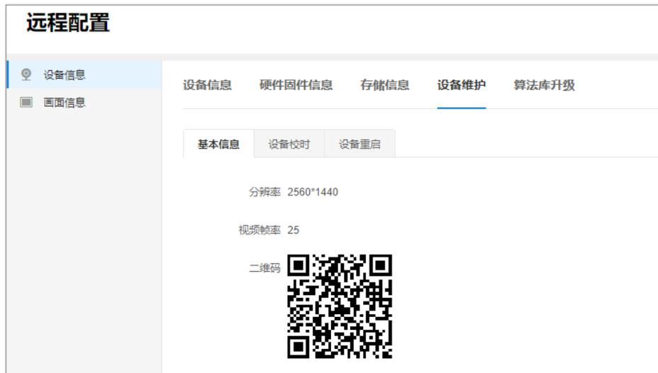
远程配置界面：设备信息 >> 设备维护 >> 设备校时，可选择监控设备校时方式：
