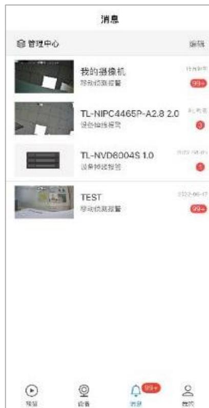
点击选择报警消息，查看报警消息详情。此处以移动侦测报警为例，点击下方<报警录像>，可查看事件触发时间段内监控设备的录像；点击<实时监控>，进入当前监控设备预览页面；点击右下角<🗑️>按钮，删除此条报警消息。
